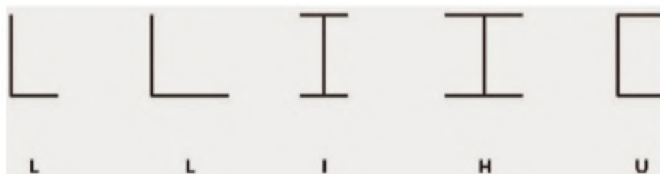
Figura 9.1 – Tipos de perfis laminados.
