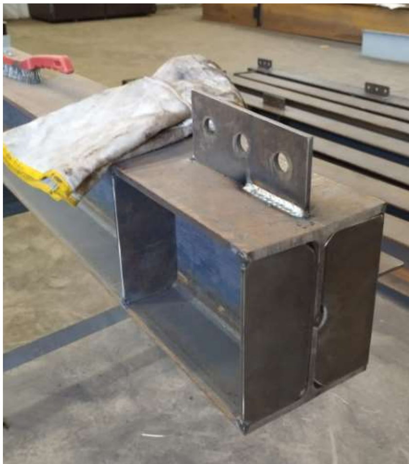
Figura 3.2 – Exemplo de soldagem da chapa.
