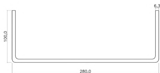
Figura 4.25 – Perfil de aço dobrado usinado.
