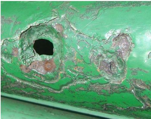
Figura 5 - **Corrosão perforante** em regiões de aço revestido.
