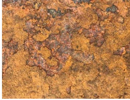
Figura 4 - **Corrosão severa** em aço exposto, com incidência de alvéolos rasos.
