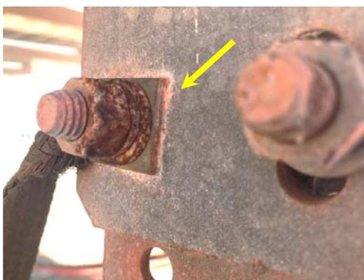
Figura 10 - **Corrosão galvânica** devido ao contato elétrico do revestimento de zinco com chapa de cobre do sistema de aterramento.
