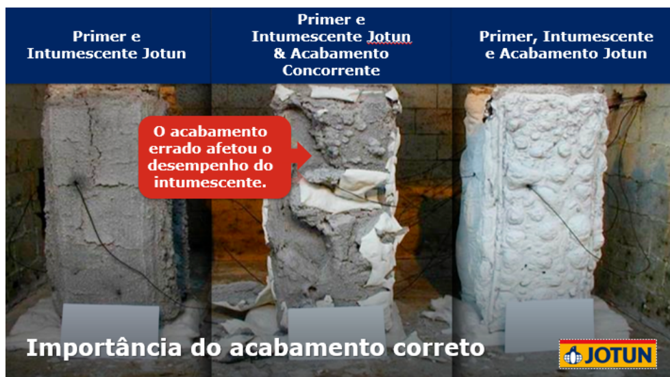
Figura 5 – Exemplo de revestimentos de acabamento exposto ao teste de fogo
